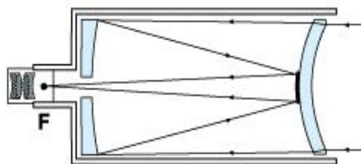
Зеркально-линзовые (катадиоптрические) телескопы используют как линзы, так и зеркала, за счет чего их оптическое устройство позволяет достичь великолепного качества изображения с высоким разрешением, при том, что вся конструкция состоит из очень коротких портативных оптических труб.
