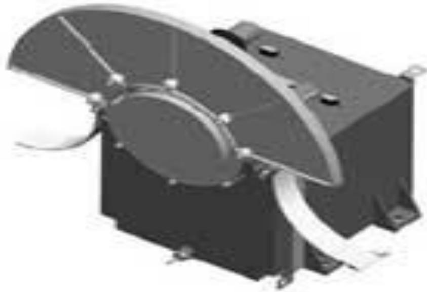
Роль спектрометра энергичных частиц PEPSSI (Pluto Energetic Particle Spectrometer Science Investigation) состоит в поиске нейтральных атомов в атмосфере Плутона, которые приобретают заряд под действием ультрафиолета и уносятся с солнечным ветром. В целом его задачи во многом схожи с тем, чем будет заниматься прибор SWAP, но PEPSSI сможет определять энергию частиц вплоть до 1000 кэВ
