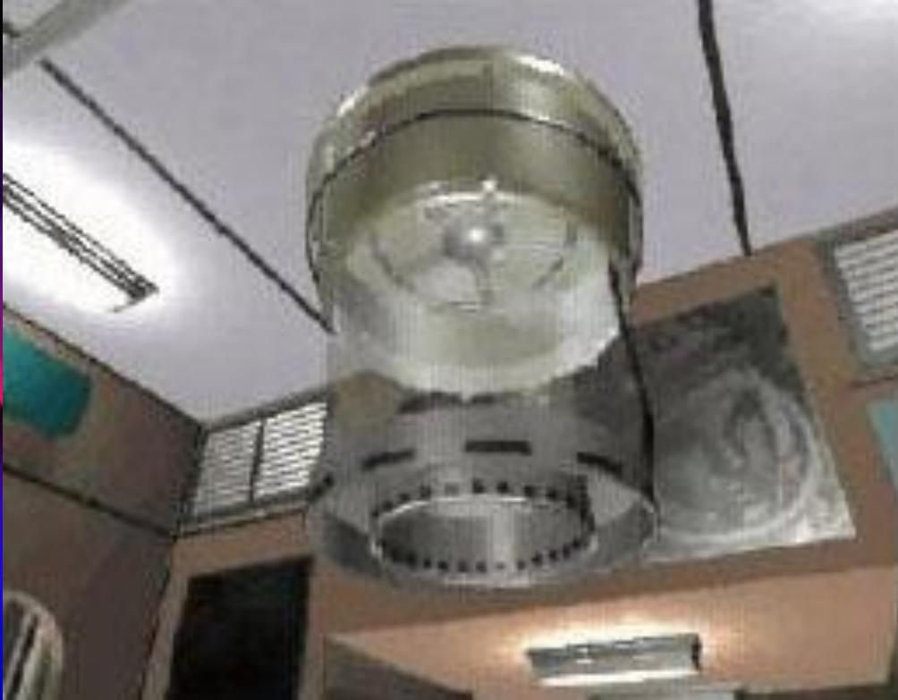
Для того чтобы принять душ, его нужно развернуть и прикрепить к потолку. Цилиндр имеет верхнюю и нижнюю крышки. На верхней крышке имеются краны, через которые поступает холодная и горячая вода и теплый воздух. В нижней крышке находится устройство, при помощи которого удаляется использованная вода. К ней же космонавт крепится ногами, чтобы не перемещаться по цилиндру.
