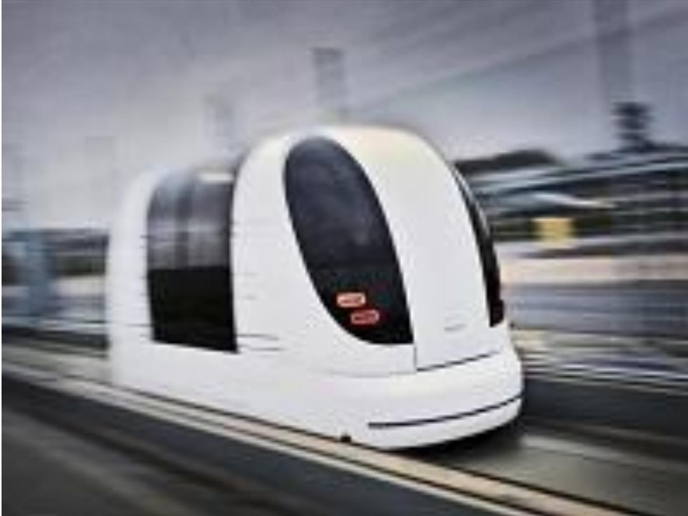
la commune de Milton Keynes a décidé de mettre en place des minibus sans chauffeur. ces petits véhicules ont l'allure de minuscules rames de métro ou de tramway automatiques. Ils sont animés par un moteur électrique capable de les faire rouler à une vitesse d'environ 20 km/h.
