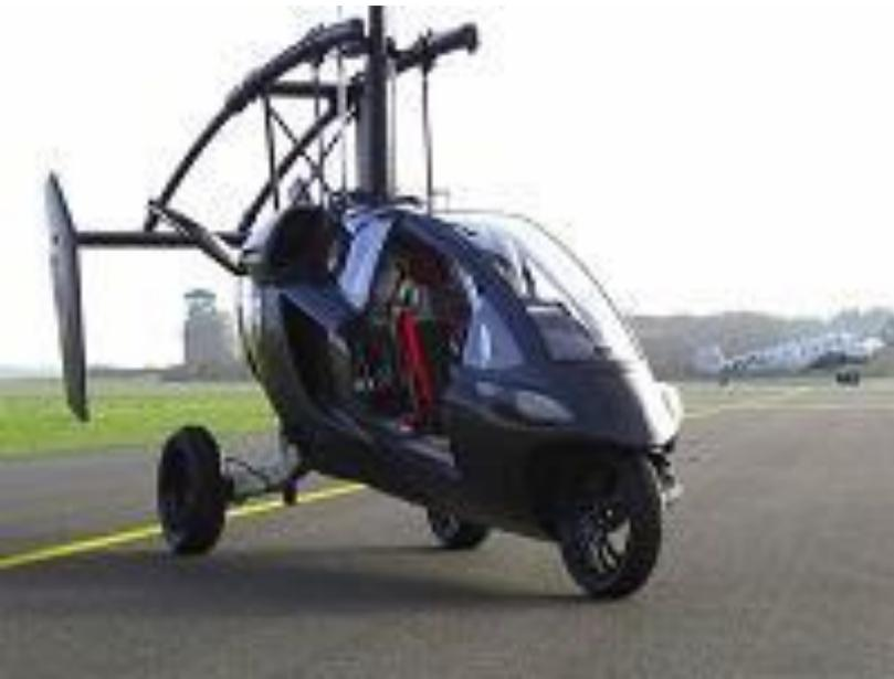
Doté de 3 roues, il possède une conduite similaire aux voitures de course et peut atteindre 100 km/h en 8 secondes et 180 km/h en vitesse de pointe. Plus silencieux qu'un véritable hélicoptère, le Pal-V One est facile à contrôler. Sa commercialisation est prévue pour 2014. Une licence de pilote sera exigé pour s'envoler mais un permis B sera suffisant pour le conduire.
