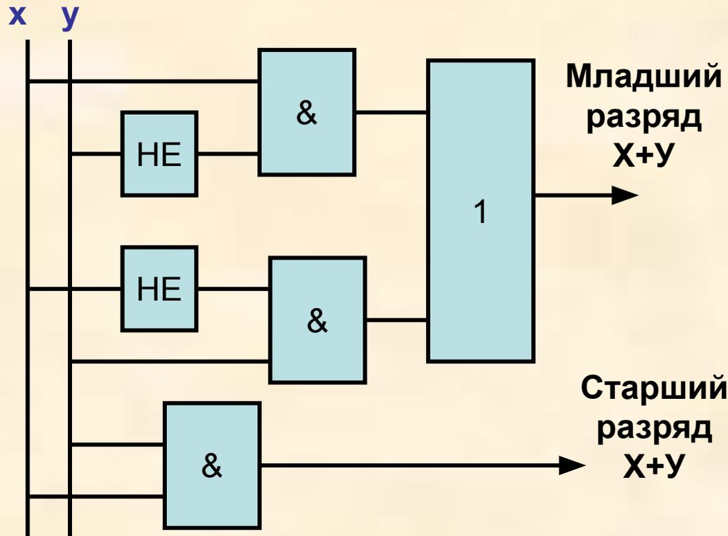
Подавая на входы x и y сигналы 0 и 1, на выходах получим два сигнала, которые поразрядно кодируют сумму двух однозначных чисел.
