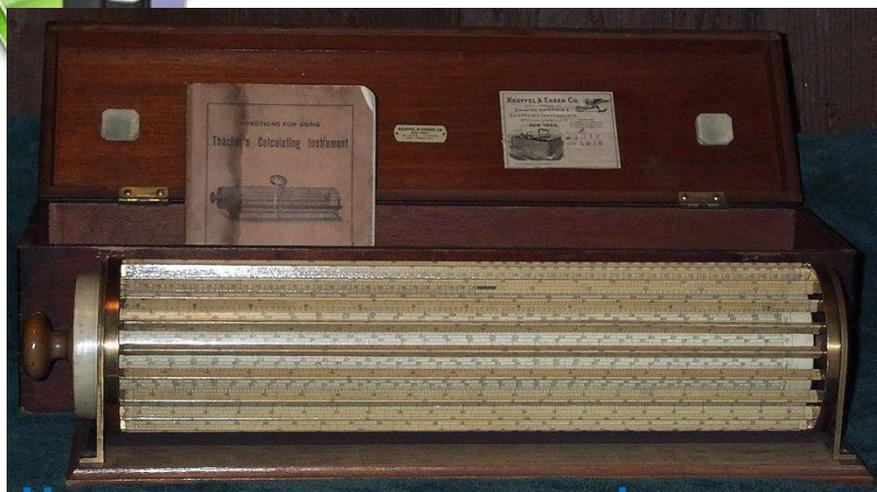
**Цилиндрическая логарифмическая линейка**
